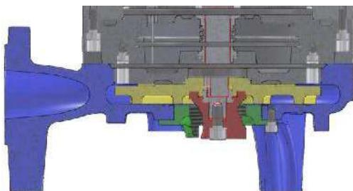
Elettropompe sommergibili caratterizzate da una girante aperta e dotata di un sistema per sminuzzare e tritare fibre. Questa soluzione idraulica definisce piccoli passaggi liberi di corpi solidi e un buon rendimento della pompa. Soluzione indicata per il pompaggio di acque luride e reflui civili ed industriali contenenti fibre lunghe.
