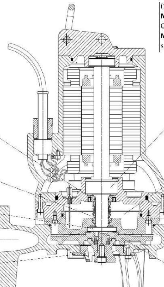
**Motore asincrono** in classe di isolamento F (155°C), a secco e raffreddato dal liquido circostante;
