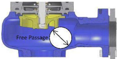
Elettropompe sommergibili caratterizzate da una girante semiaperta arretrata - Vortex System. Questa soluzione idraulica garantisce un ampio passaggio libero di corpi solidi riducendo il pericolo di blocco della girante. Soluzione molto indicata per il pompaggio di acque luride e reflui civili ed industriali.
